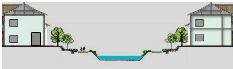
附图 10 “亲水型”驳岸方式示意图
